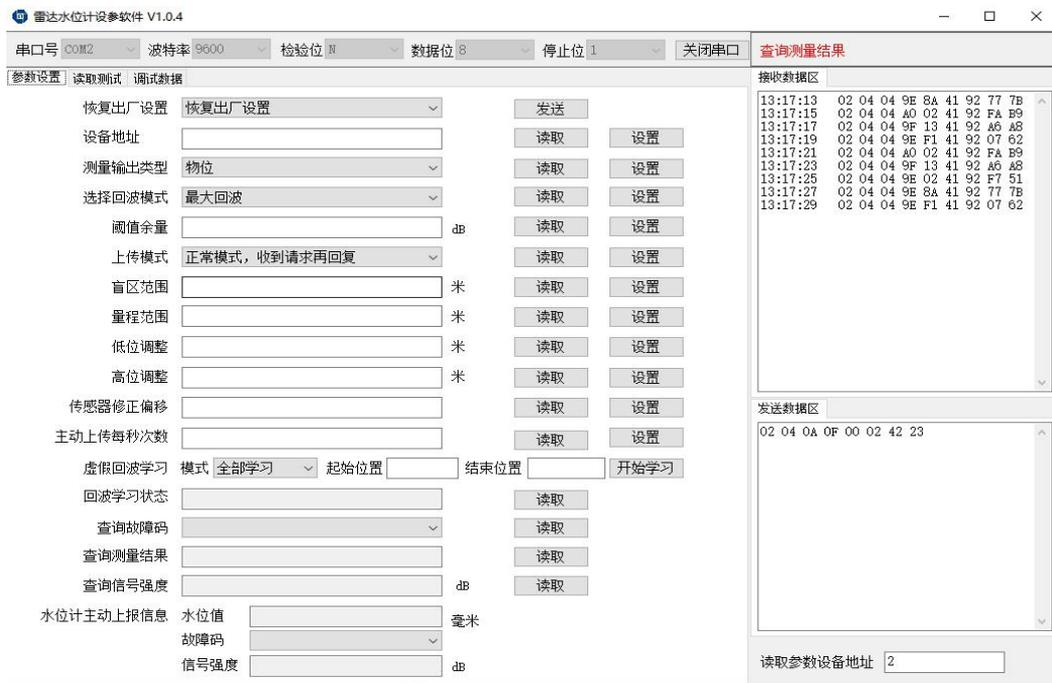
【测量输出类型】可以根据现场需要，选择距离信息输出形式。核心参数是传感器参考点到待测物的测试距离。表 4-1 给出了实时值具体的计算公式。其中高位调整默认是 0。
