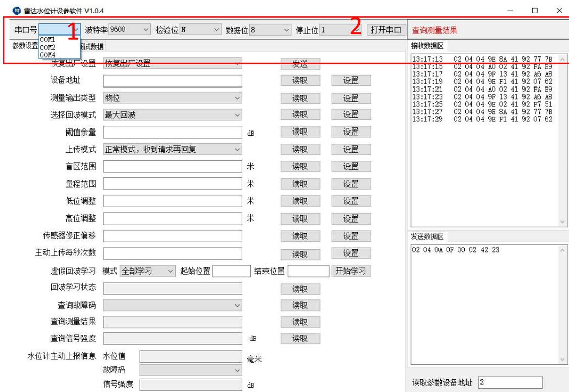
按照图中顺序配置设备串口参数，波特率 9600，单击“打开串口”，连接成功后可以设置和读取参数。
